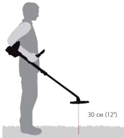
Рисунок 17 – Правильное положение детектора для отстройки от помех
